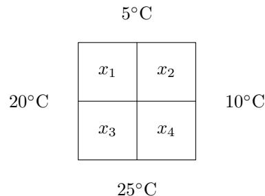
Z jihu je dům ohříván průměrnou teplotou  $25^\circ\text{C}$ , z východu  $10^\circ\text{C}$ , ze západu  $20^\circ\text{C}$  a ze severu  $5^\circ\text{C}$ . Určete teplotu  $x_1, \dots, x_4$  v jednotlivých místnostech pokud známe (zjednodušenou) fyzikální poučku, že teplota dané oblasti je průměrem teplot okolních oblastí.
